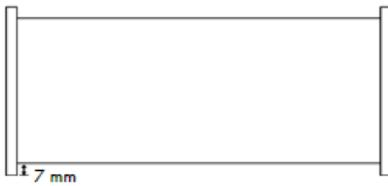
Der Abstand zwischen der Vorderkante der Regalseite und der Vorderkante des Fachbodens beträgt 7 mm. Die Fachböden sind höhenverstellbar im Abstand von 25 mm.
